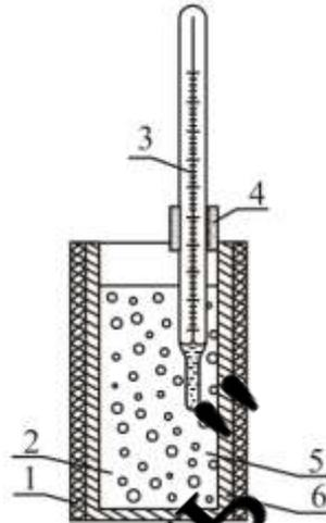
1 – теплоизоляция; 2 – ацетон или изопропиловый спирт; 3 – термометр; 4 – держатель;
