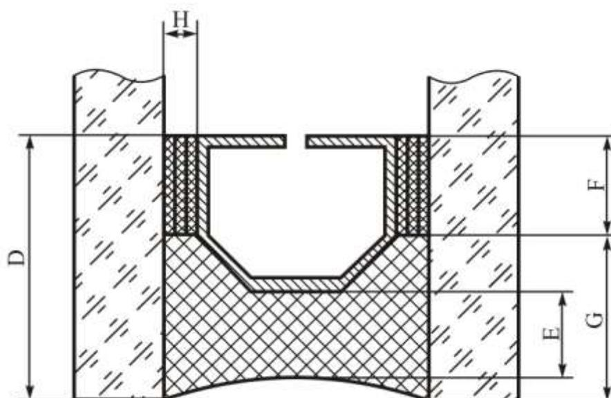
$D$  – общая глубина герметизирующих слоев;  $F$  – глубина внутреннего (первичного) герметизирующего слоя;  $G$  – глубина вторичного герметизирующего слоя;  $E$  – глубина наружного герметизирующего слоя;  $H$  – толщина первичного герметизирующего слоя
