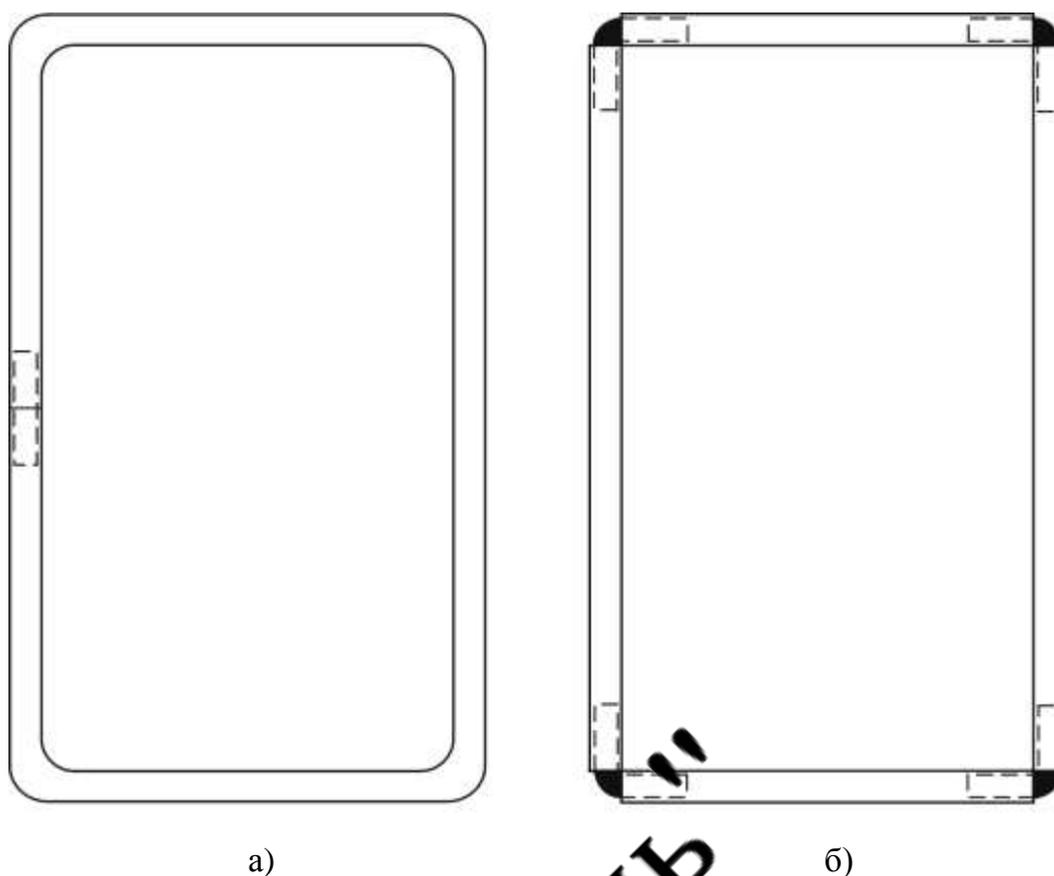
П р и м е ч а н и е – Вариант а), (рекомендуемый): дистанционная рамка, изготовлена методом гнутья и замкнута на одном соединителе (или нескольких соединителях); вариант б), (допускаемый): дистанционная рамка из прямолинейных деталей, собрана на четырех соединительных уголках.
